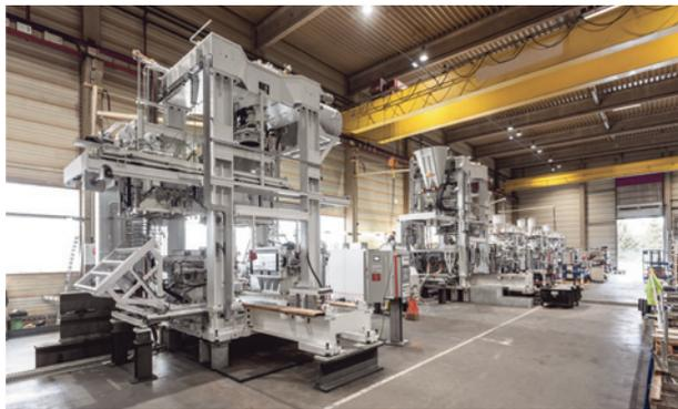
**Рис. 4.** Общий вид пескострельных автоматов типа LHL на монтажно-сборочном заводе Laempe [3]
