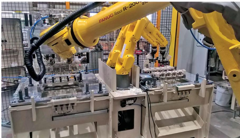
**Рис. 5.** Один из двух стационарных участков Лаемпре для зачистки заусенцев с применением мини-роботов Fanuc на литейном заводе Dongfeng
