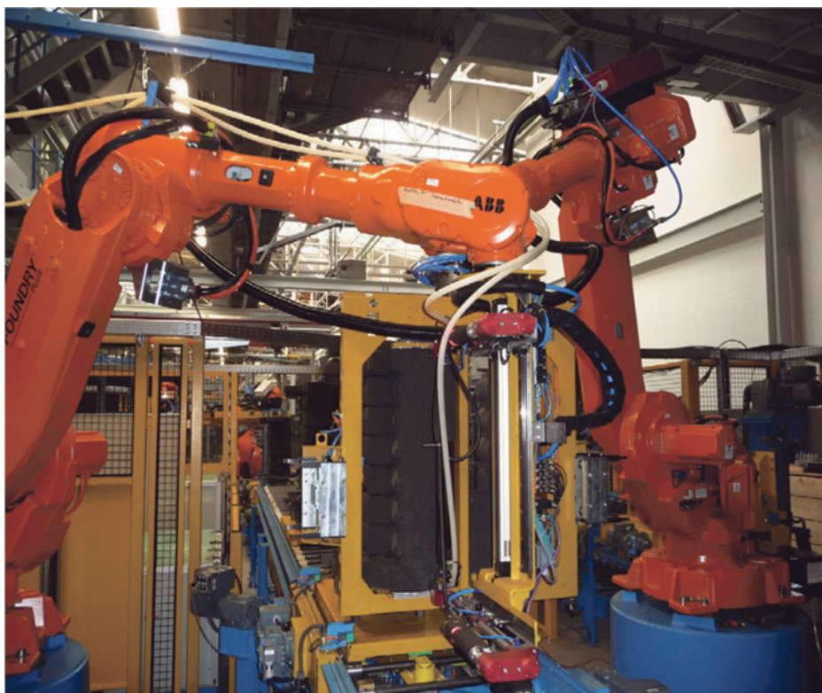
Рис. 3. Фрагмент автоматизированной технологической линии Лаемре по сборке стержней для отливок блоков двигателей для грузовых а/м на чугунолитейном заводе концерна Daimler AG, г. Мангейм, Германия. Применяемая технология: Coldbox-Амин-процесс
