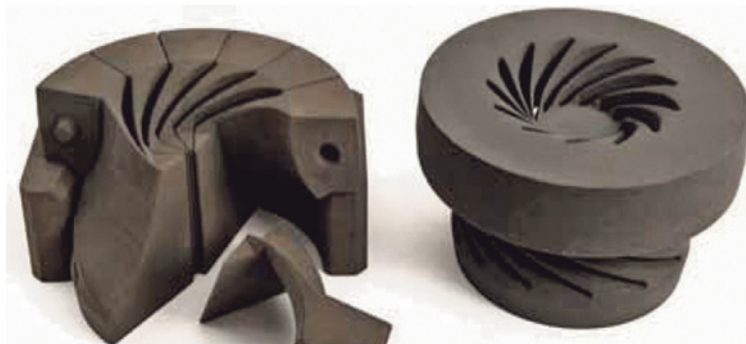
Рис. 6. Общий вид стержня после 3D-печати (справа), а также традиционная технология его изготовления отдельными элементами (слева) [31]
