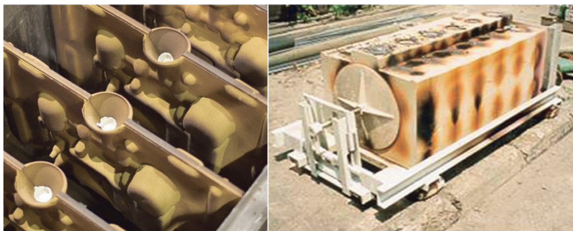
Рис. 2. Примеры 90-тых годов прошлого века из опыта Laempe применения метода пакетной формовки («литья в стержневых формах») для мелкосерийного производства отливок из ВЧ. Стержневые формы на фото слева произведены на стержневых машинах Rperwerk (с 2009 г. входит в состав группы Laempe) по методу Shell (Croning), а на фото справа — на пескострельных автоматах Laempe по «холодному» Resol-СО 2 -процессу
