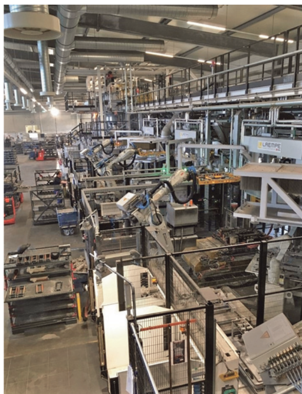
Рис. 5. Фрагмент автоматизированного стержневого участка Laetpre для производства стержней по BeachBox-процессу на немецком заводе Inacore в г. Энголдсбах (Бавария)
