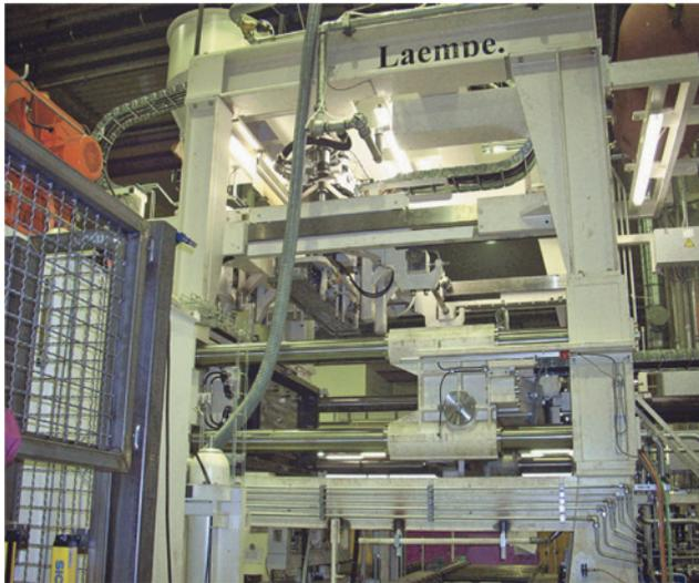
**Рис. 1.** Общий вид пескострельного автомата Laetpre типа LCB190 на заводе «Вейфанг»
