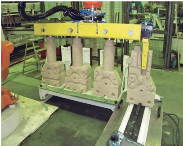
**Рис. 2.** Общий вид мультифункционального захвата для робота во фронтальной части двух пескострельных автоматов LCB190 для съема и поверхностной обработки центровых стержней для отливок 6-цилиндровых рядных блоков грузовых двигателей «Вейфанг»
