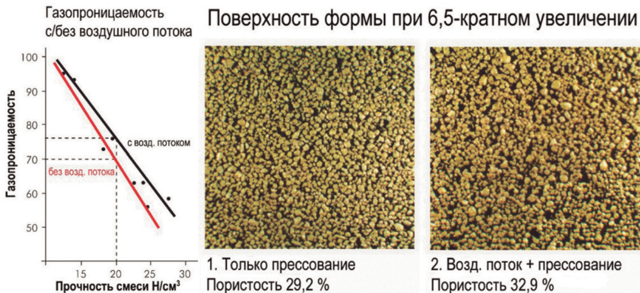
График 3. Результаты исследований по газопроницаемости форм в сравнении Сейатцу-процесса с традиционным прессованием без воздушного потока
