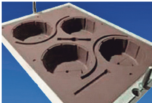
Рис. 4. КамАЗ — 4 отливки «тормозного барабана» в одной форме. Размер опок 1500×1100×400/400 мм. На КамАЗ работают две АФЛ фирмы HWS-Sinto по Сейатцу-процессу
