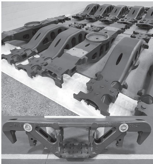
**Рис. 2.** Первые образцы качественных крупных ЖД отливок «рама боковая» и «балка наддресорная» по технологии ВПФ. Завод Grinco, США
