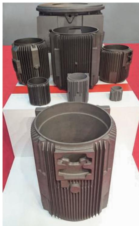
**Рис. 1.** Отливки корпусов электродвигателей разной высоты (до 950 мм) завода Olsberg (Сейатцу-процесс)
