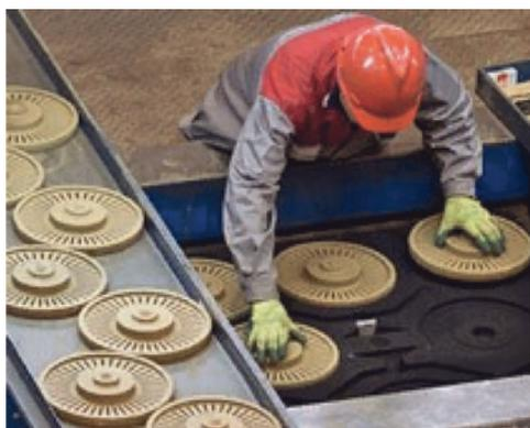
Рис. 2. АФЛ немецкой фирмы HWS-Sinto по Сейатцу-процессу для вентилируемых тормозных дисков на заводе Brembo в Китае
