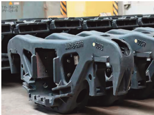
Рис. 3. Отливки «рама боковая», экспортируемые в США, Канаду, Мексику — произведены на ТВСЗ (г. Тихвин) по технологии ВПФ
