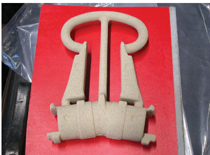
Рис.2. Общий вид стержня, изготовленного по технологии Veach-Vox для отливки арматуры из латуни
