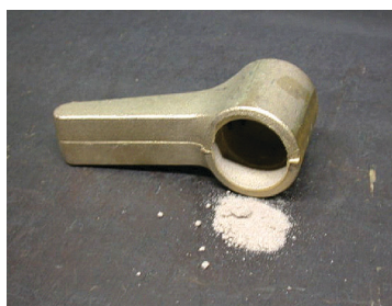
Рис.5. Отливка после выбивки с остатками выбитого стержня
