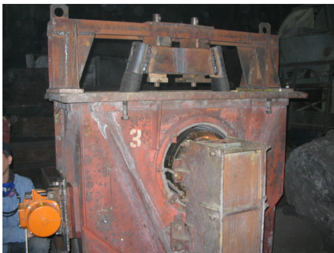
«Установка сухой набивной массы для индуктора 40 тонной канальной печи при помощи EVS»
