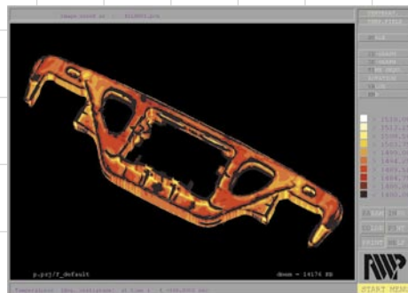
Моделирование дефектов отливки
