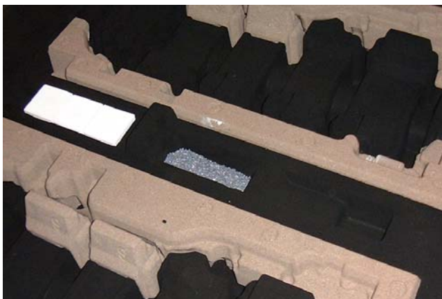
Рис. 2. Система PQ-CGI® InMold подразумевает использование регуляторов потока металла и давления, а также фильтра для обеспечения равномерного усвоения магнийсодержащего модификатора. Приведенная выше фотография демонстрирует часть формы с реакционной камерой, наполненной модификатором.
