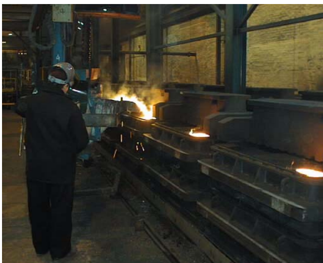
Рис. 4. Заливка с использованием PQ-CGI® InMold – нет видимой реакции (интенсивного выделения газов и пламени).
