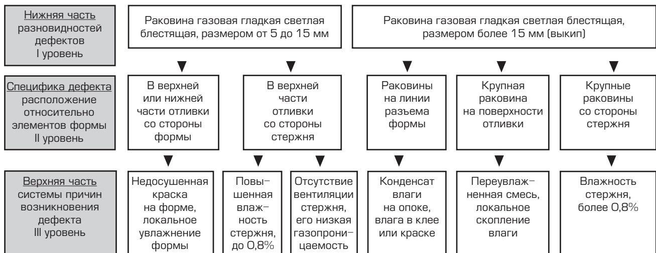
Рис. 5. Графа выявления причин возникновения крупных светлых газовых раковин на основе цепочек причинно-следственных связей
