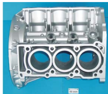
Рис. 5. Блок цилиндров (материал – алюминий, производитель Honsel, Германия)
