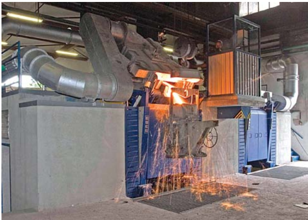
Блок печей емкостью 4 т мощностью 3 МВт, система MELT&HOLD (плавки и выдержки), Чехия
