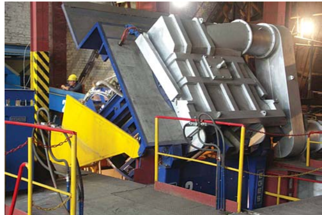
Печь емкостью 8 т, установленная на Луганском литейно-механическом заводе, Украина
