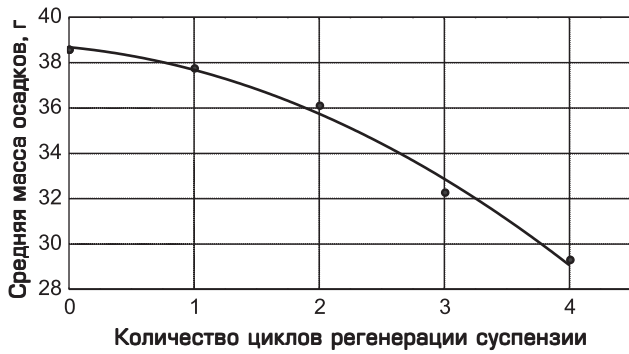
Рис. 1. Зависимость массы оболочек, полученных методом электрофореза, от количества циклов регенерации суспензии
