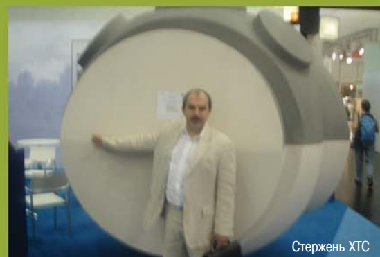
Корпус ветряного генератора по ХТС-процессу. Вес – 43000 кг
