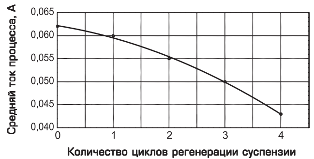
Рис. 3. Зависимость тока при получении оболочек методом электрофореза от количества циклов регенерации суспензии
