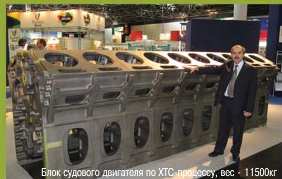
Блок судового двигателя по ХТС-процессу, вес – 11500кг
