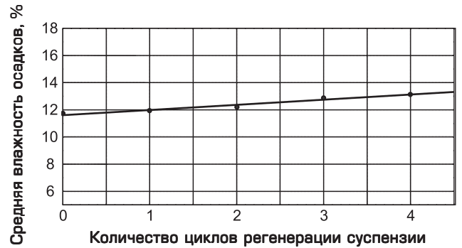
Рис. 2. Зависимость влажности оболочек, полученных методом электрофореза, от количества циклов регенерации суспензии
