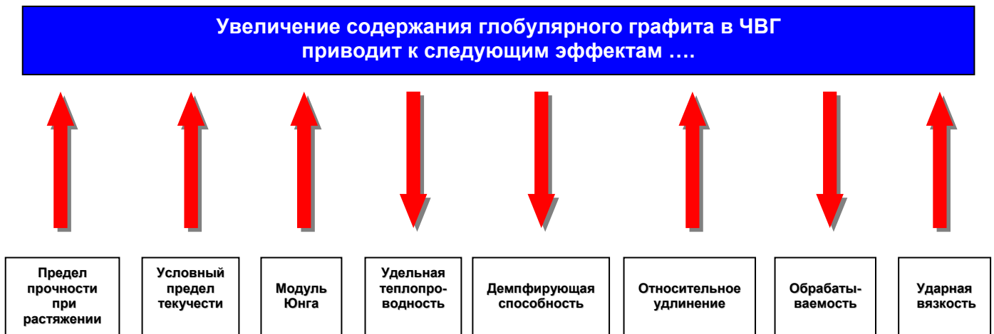
Рисунок 4: Влияние увеличения степени шаровидности графита на некоторые свойства ЧВГ.
