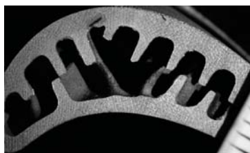
Рис. 5. Макроструктура фрагмента поперечного сечения средней части пера лопатки 1-й ст. ТВД из сплава ЧС88-ВИ (НК). В структуре фрагмента - 17 зерен с КГО каждого зерна {001}
