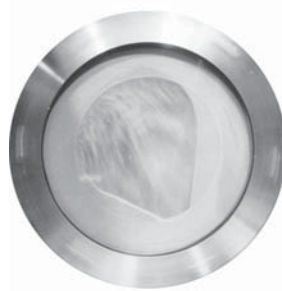
Рис. 3. Движение песка в рабочей емкости ЦЛС с горизонтальной осью вращения при n = 600 об./мин и K_s = 0,4
