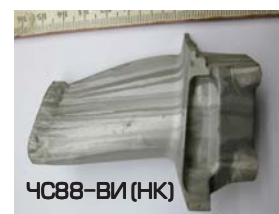
Рис. 4. Вид макроструктуры, изготавливаемых серийно лопаток 2-й ст. ТНД SaM 146 (сплав DS200) и 1 ст. ТВД двигателей наземной тематики (сплав ЧС88 ВИ (НК))
