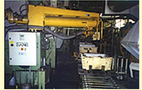
Двухрукавный смеситель T36/20S фирмы IMF
