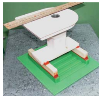
Рис. 2. Вид блока моделей для получения заготовок под затравки
