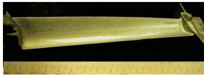
Рис. 1. Типичная макроструктура лопаток 2-й ст. ТНД SaM 146, полученная на установке УВНК9П с применением обычной технологии литья без затравок
