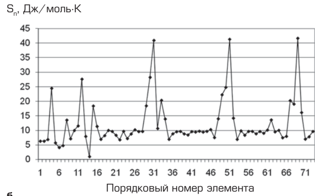
Рис. 1. Изменение свойств элементов в зависимости от атомного номера: а – температура плавления, б – энтропия плавления
