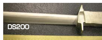
Рис. 4. Вид макроструктуры, изготавливаемых серийно лопаток 2-й ст. ТНД SaM 146 (сплав DS200) и 1 ст. ТВД двигателей наземной тематики (сплав ЧС88 ВИ (НК))
