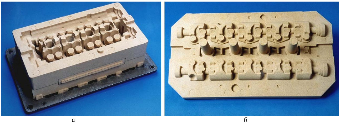
Рис. 2. Форма для заливки головки блока цилиндров из алюминиевого сплава, изготовленная по технологии формовки в стержнях (а); верхний стержень (б) (предоставлено Powertrain Ltd.)
