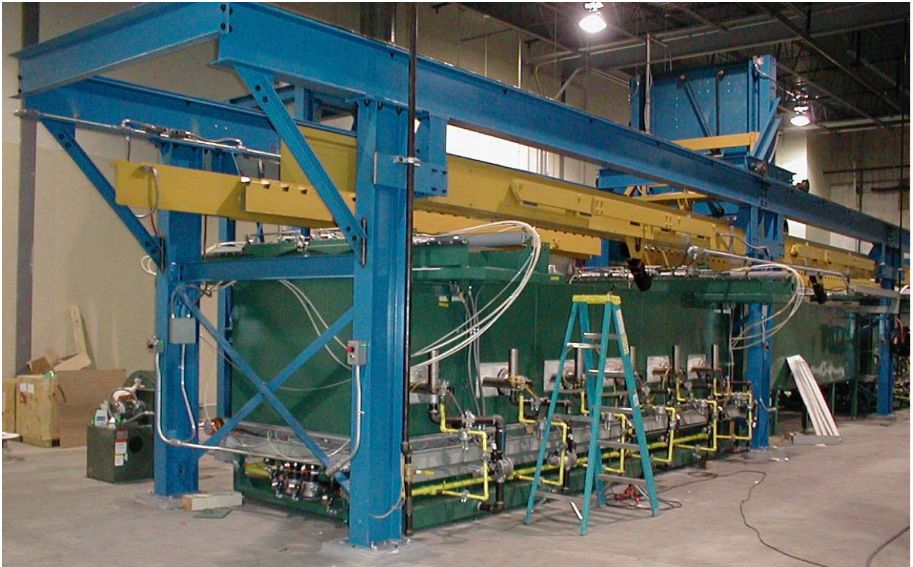
Рис. 5. Фотография установки с кипящим слоем (предоставлено Technoomics LLC, Миннеаполис, Миннесота, США)
