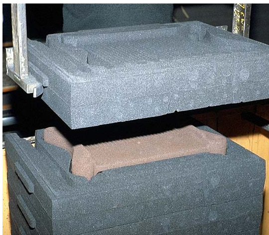
Рис. 3. Собранные формы (ФОПТ) для литья чугунных теплообменников, изготовленные методом стопочной формовки (предоставлено Ideal Boilers Ltd.)
