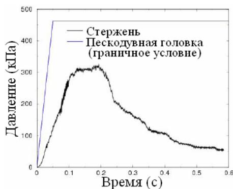
Рис. 15. Динамика изменения давления в стержне и пескодунной головке
