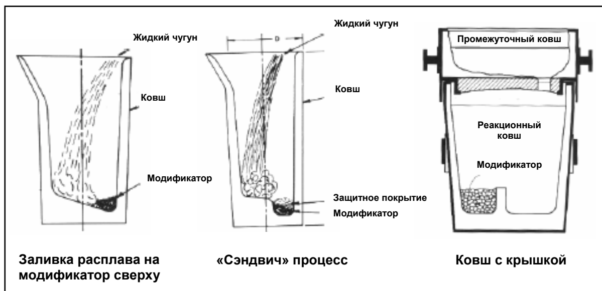
Рис. 1. Примеры ковшей для модифицирования методами заливки расплава на модификатор, «сэндвич» процесс и с использованием промежуточного ковша-крышки.
