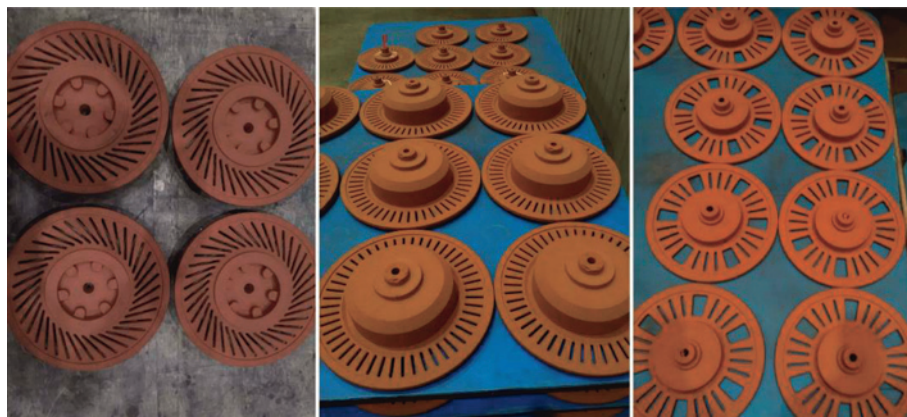
Рис. 3. Примеры стержней для отливок вентилируемых стержневых дисков, которые производятся на стержневых участках Laempe на чугунолитейных заводах Winhere
