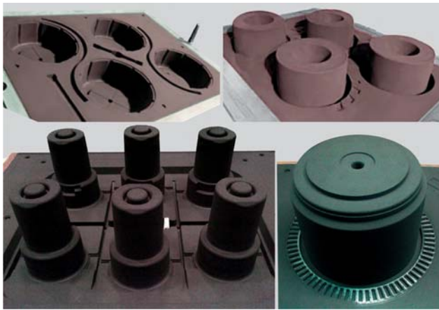
Рис. 4. Пример качества изготовления форм по Сейятцу-процессу с высокими болванами
