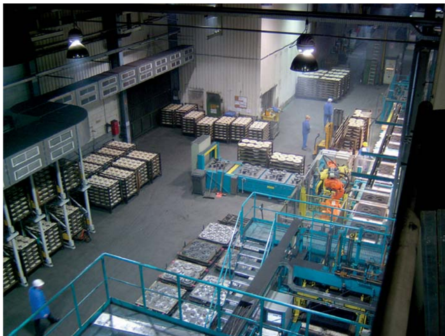
Рис. 7. Формовочная линия по Сейатцу-процессу для производства вентилируемых тормозных дисков на заводе Fritz Winter, Германия
