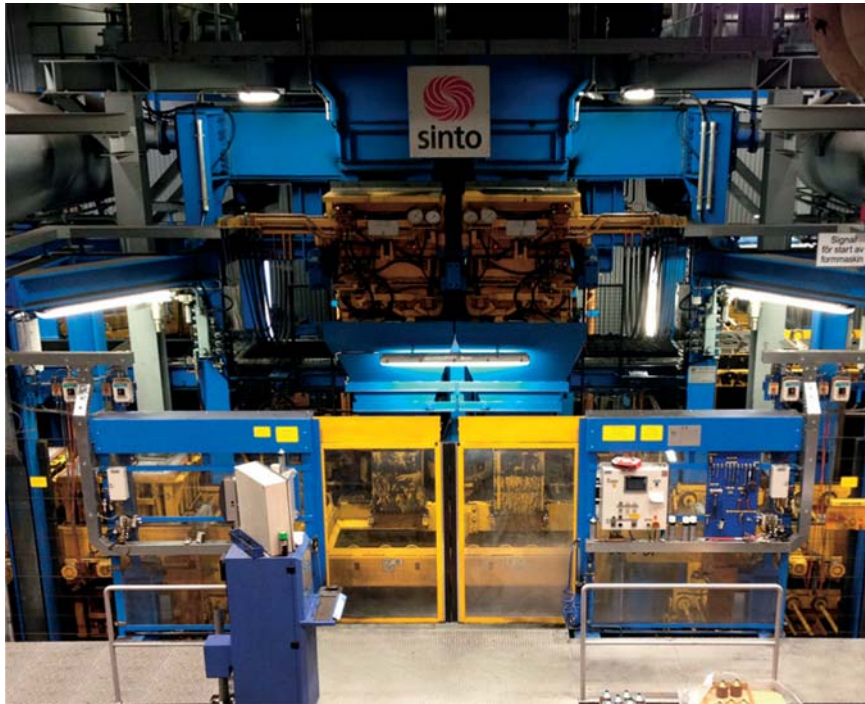
Рис. 5. Сдвоенный формовочный автомат по Сейатцу-процессу — производительность до 250 форм в час
