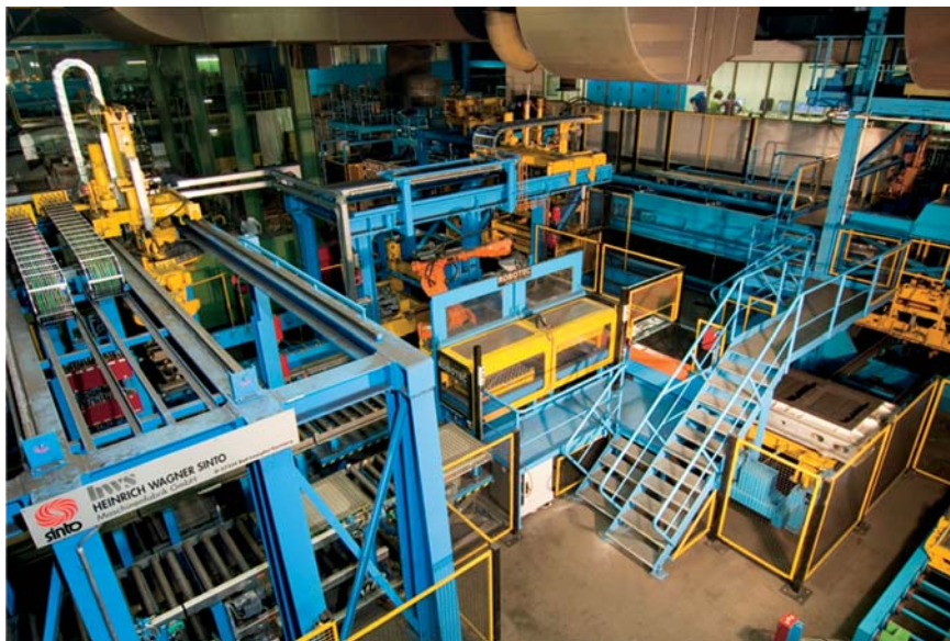
Рис. 6. Одна из трех запущенных АФЛ по Сейатцу-процессу на заводе Daimler AG в Германии
