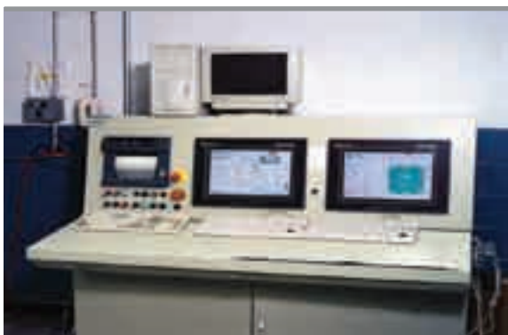
Автоматизированная система , обеспечивающая дистанционное управление всеми вспомогательными системами пресса.
