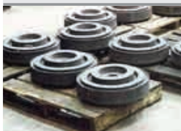
Детали сложной формы с окончательной плотностью и изотропными свойствами изготовлены из порошков с помощью ГИП.
