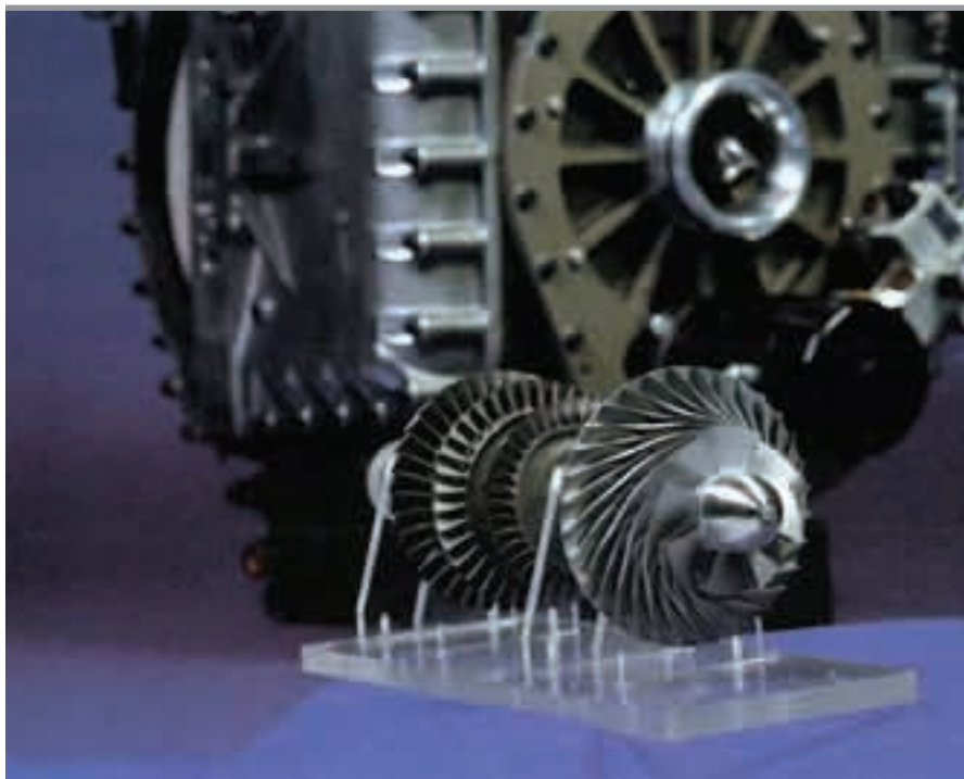
Высокоэффективное керамическое колесо турбины , разработанное в сотрудничестве со шведским предприятием United Turbine. Для его изготовления используется запатентованный фирмой AVURE метод прессования в стеклянной оболочке почти до окончательной формы.
