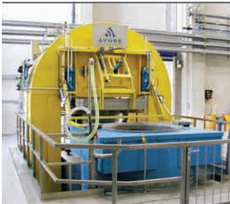
Пресс с рабочим давлением 250 МПа (36,000 psi) диаметром 1.3 м (51 дюйм.), высотой 3м (118 дюймов).
