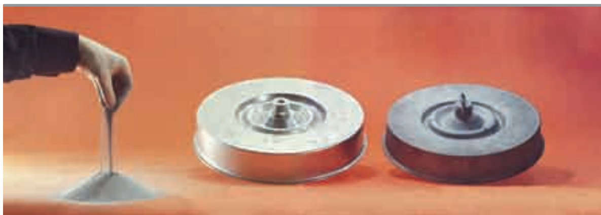
Детали сложной формы с окончательной плотностью и изотропными свойствами изготовлены из порошков с помощью ГИП.
