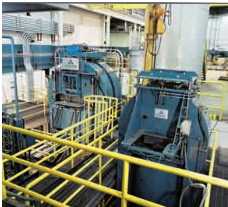
Пресс с рабочим давлением 414 МПа (60,000 psi), диаметром, 0.61 м. высотой 2.03 м
