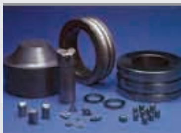
Детали сложной формы с окончательной плотностью и изотропными свойствами изготовлены из порошков с помощью ГИП.
