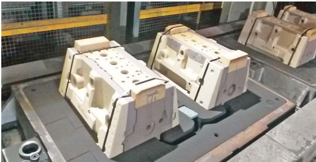
Рис. 6. Нижние полуформы с проставленными стержневыми пакетами на чугунолитейном заводе FAW № 2
