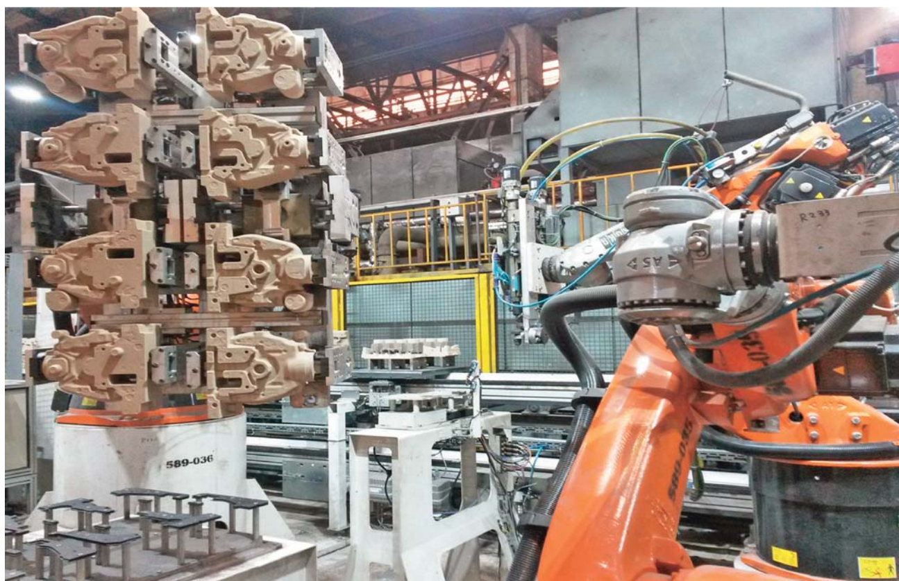
Рис. 3. Общий вид участка съема стержней и очистки заусенцев «центровых» стержней
