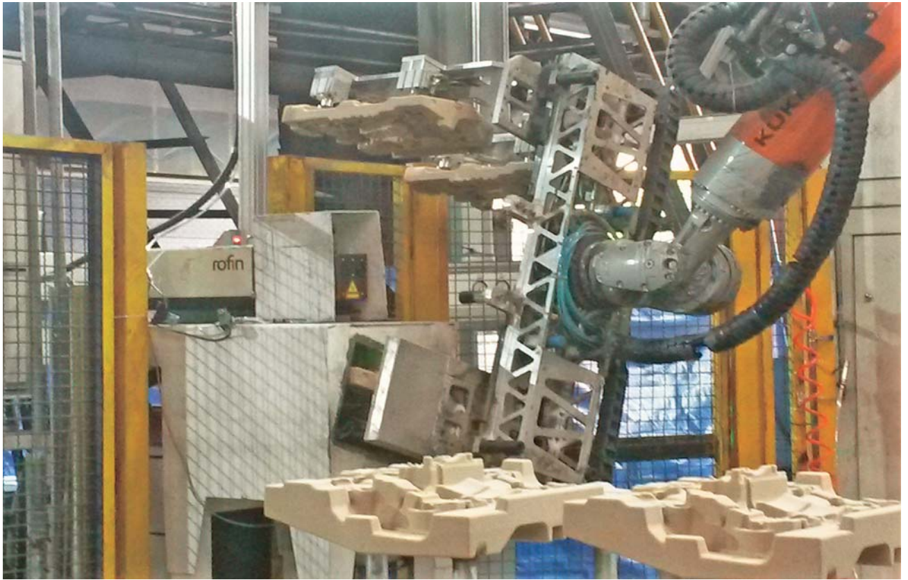
Рис. 4. Участок производства «торцевых» стержней на автоматизированной линии Laemre
