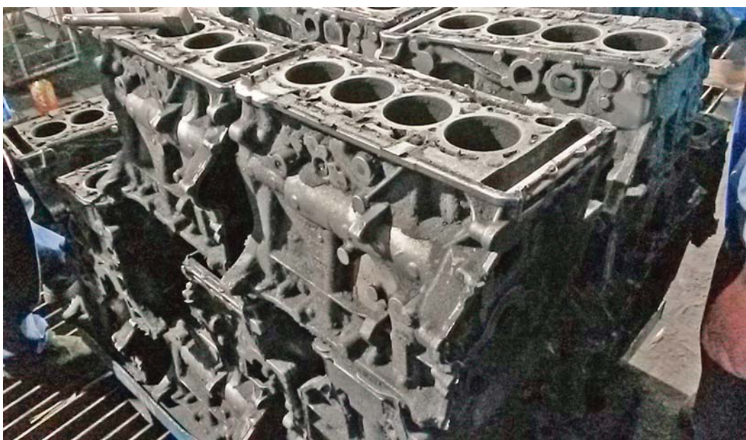
Рис. 7. Отливки после выбивки форм на чугунолитейном заводе FAW № 2
