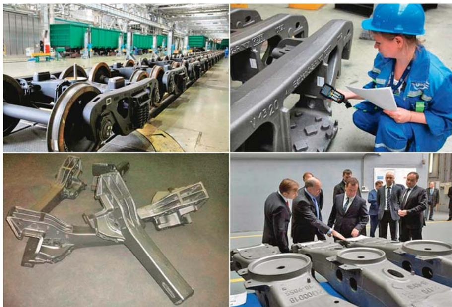
Рис. 6. Все крупные и средние ЖД отливки ТВСЗ изготовлены по ВПФ
