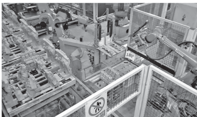
Рис. 4. Фрагмент автоматизированной линии Laetpre на заводе Hua Dong Teksid в зоне поэтапной загрузки накопительного конвейера перед участком окрашивания промежуточных стержневых пакетов
