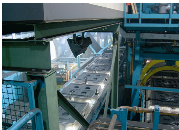
Рис.9. Участки АФЛ фирмы HWS-Sinto, Германия по Сейатцу-процессу на заводе Fritz Winter, Германия (опока 1120x1080x350/250 мм, 250 ф/час, отливки тормозных дисков для грузовиков).
