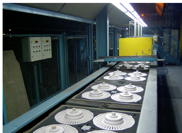
Рис.9. Участки АФЛ фирмы HWS-Sinto, Германия по Сейатцу-процессу на заводе Fritz Winter, Германия (опока 1120x1080x350/250 мм, 250 ф/час, отливки тормозных дисков для грузовиков).
