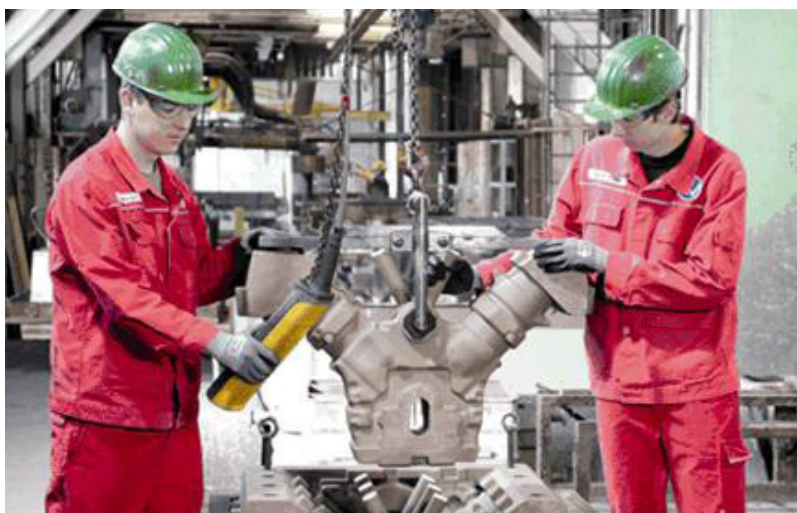
Рис. 6. Пример сборки стержней грузового V8 блока в пакет.
