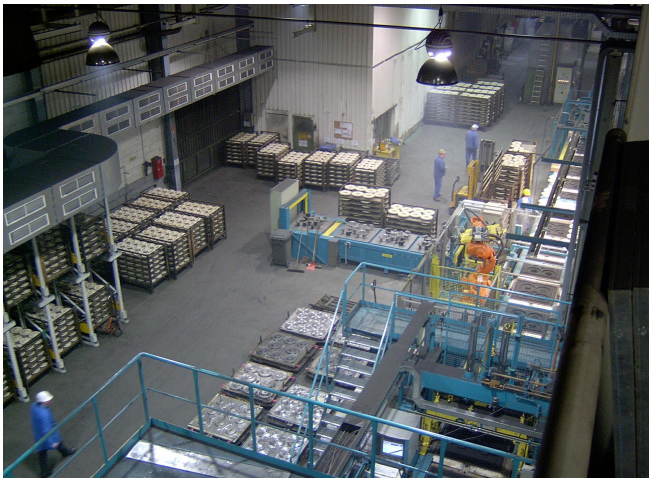
Рис. 8. Вид сверху на участок автоматической протановки стержней АФЛ фирмы HWS-Sinto. Завод Fritz Winter.
