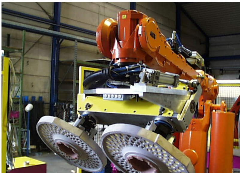
Рис. 5. Примеры съема стержней вентилируемых тормозных дисков для грузовых машин на чугунолитейном заводе Fritz Winter, Германия.
