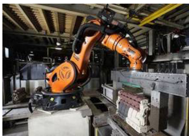
Рис. 4. Фрагменты автоматизированного участка производства стержневых пакетов для грузовых блоков на чугунолитейном заводе Fritz Winter, Германия.
