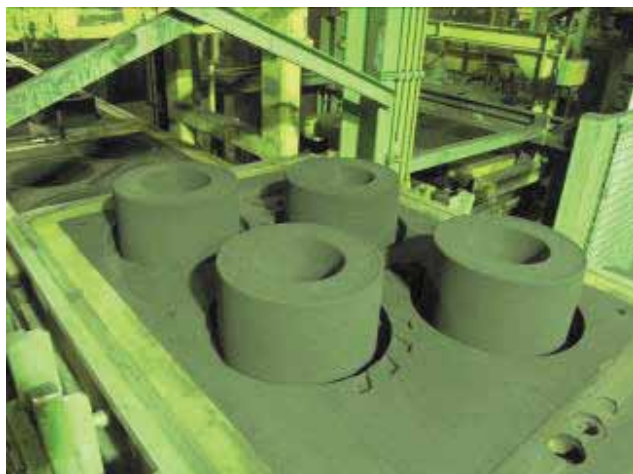
17 18 19 20 21 22 23 24 25 26 27 28 29 Рис. 3. Полуформы низа для отливки «тормозного барабана» 30 на одной из двух линий HWS-Sinto, Германия в цехе 31 чугунного литья на заводе КамАЗ, г.Набережные Челны 32 (размер опок 1500x1100x400/400 мм.)
