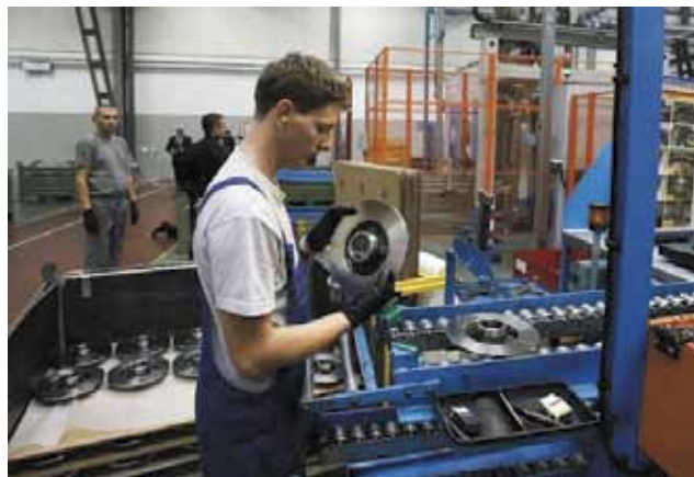
Рис. 9. Выдача готовых и обработанных отливок тормозных дисков. Завод Brembo, Польша
