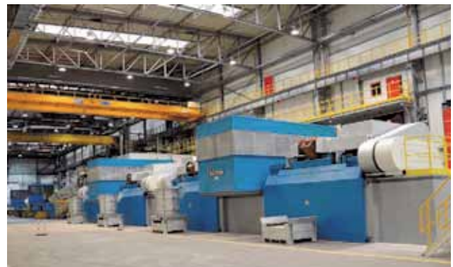
Рис. 6. Плавильное отделение завода Brembo оборудовано индукционными печами Inductotherm
