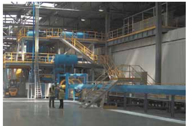
Рис. 6. Плавильное отделение завода Brembo оборудовано индукционными печами Inductotherm
