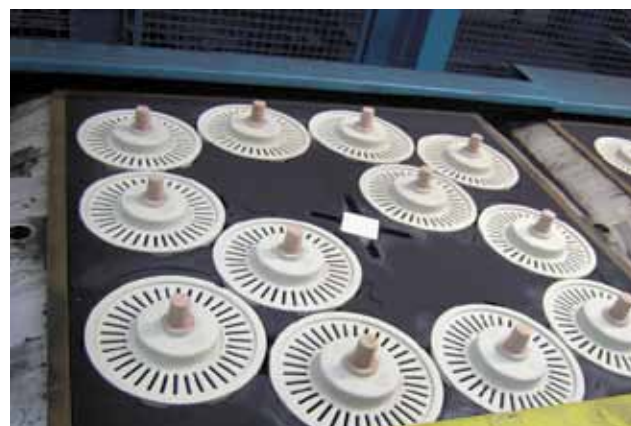
Рис. 2. Завод Fritz Winter (Германия): АФЛ по Сейатцу-процессу фирмы HWS-Sinto, Германия производительностью 250 ф/ч. Опока низа с проставленными стержнями вентилируемых тормозных дисков. В одной опоке производят 12 отливок дисков для автозавода BMW (3000 штук в час)
