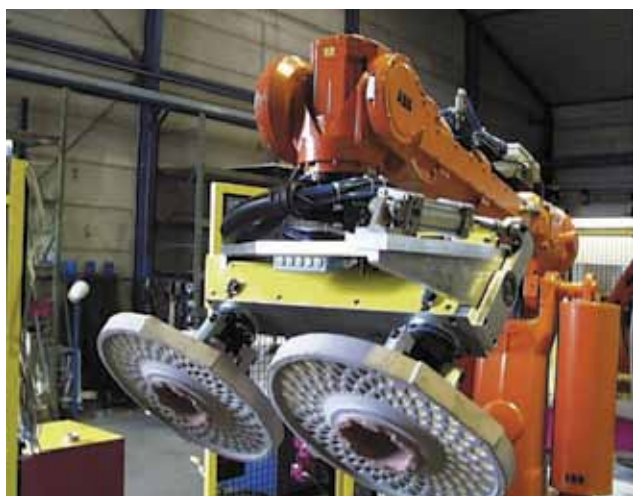
33 34 35 36 37 38 39 40 41 42 43 44 45 Рис. 4. Стержни вентилируемых тормозных дисков для 46 грузовиков от центров Laempe на заводе Fritz Winter, 47 Германия 48
