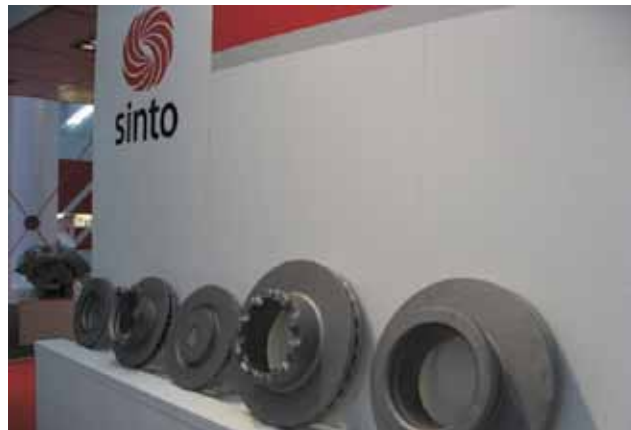
Рис. 1. Вентилируемые тормозные диски различных производителей, выполненные на опочных формовочных линиях HWS-Sinto, Германия по Сейатцу-процессу. Международная литейная выставка GIFA-2011, Дюссельдорф
