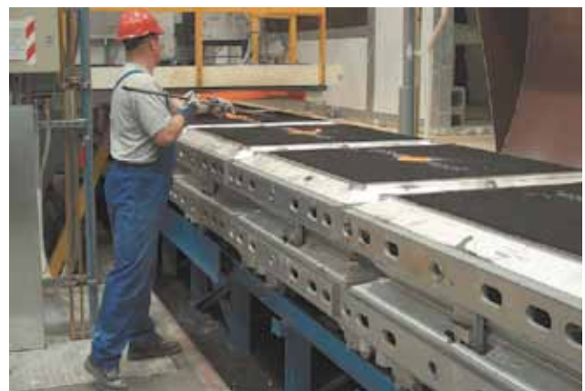
Рис. 7. Первая высокопроизводительная АФЛ Сейатцу (240 ф/ч) на заводе Brembo в Польше была запущена в 2005 году
