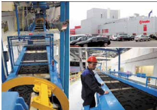
Рис. 8. Вторая формовочная линия фирмы HWS-Sinto по Сейатцу-процессу на новом заводе Brembo, Польша
