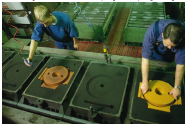
Рис.7. Участок протановки стержней формовочной линии HWS-Sinto, Германия на заводе Dania.
