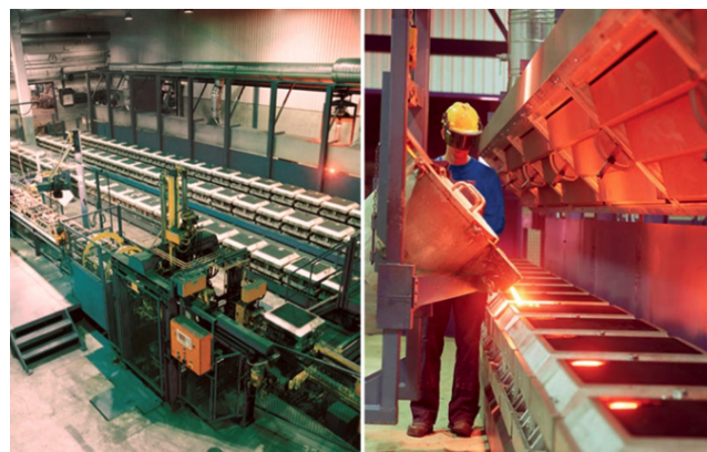
Рис.5. Формовочная линия по Сейатцу-процессу завода АВ Holsbyverken, Швеция.
