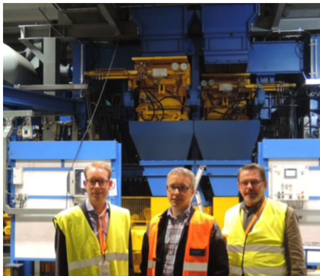
Рис.2. Новая высокопроизводительная линия фирмы HWS-Sinto, Германия по Сейатцу-процессу тип ZFA-SD 5,5 производительностью 140 ф/ч для завода Flygt. 2014 год.
