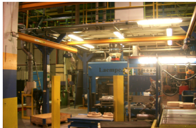
Рис.3. Фрагменты стержневого участка ГТТ в зоне действия стержневых автоматов Laempe типа LFB50.
