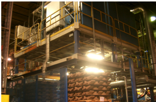
Рис.3. Фрагменты стержневого участка ГТТ в зоне действия стержневых автоматов Laempe типа LFB50.
