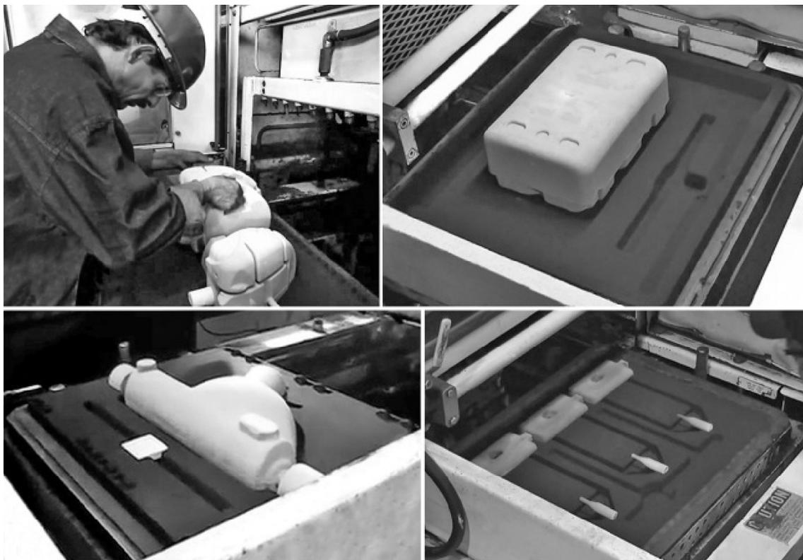
**Рис. 7.** Простановка стержней (в т.ч. крупных) в безопочную форму на машине FBO. Нижняя полуформа выдается из зоны работы машины и подается вперед для облегчения операций
