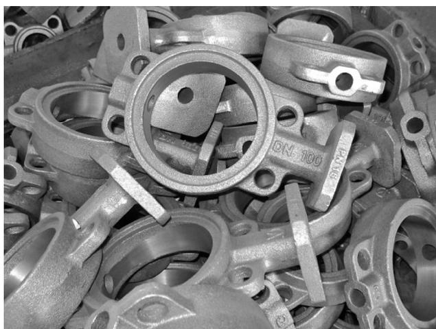
Рис. 4. Чугунная отливка запорной арматуры «Корпус Ду 100» от линии FBO-III Семеновского литейно-механического завода
