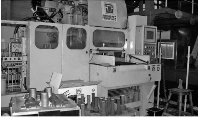
**Рис. 5.** Линия горизонтальной безопочной формовки FBO-III завода Progress, Болгария
