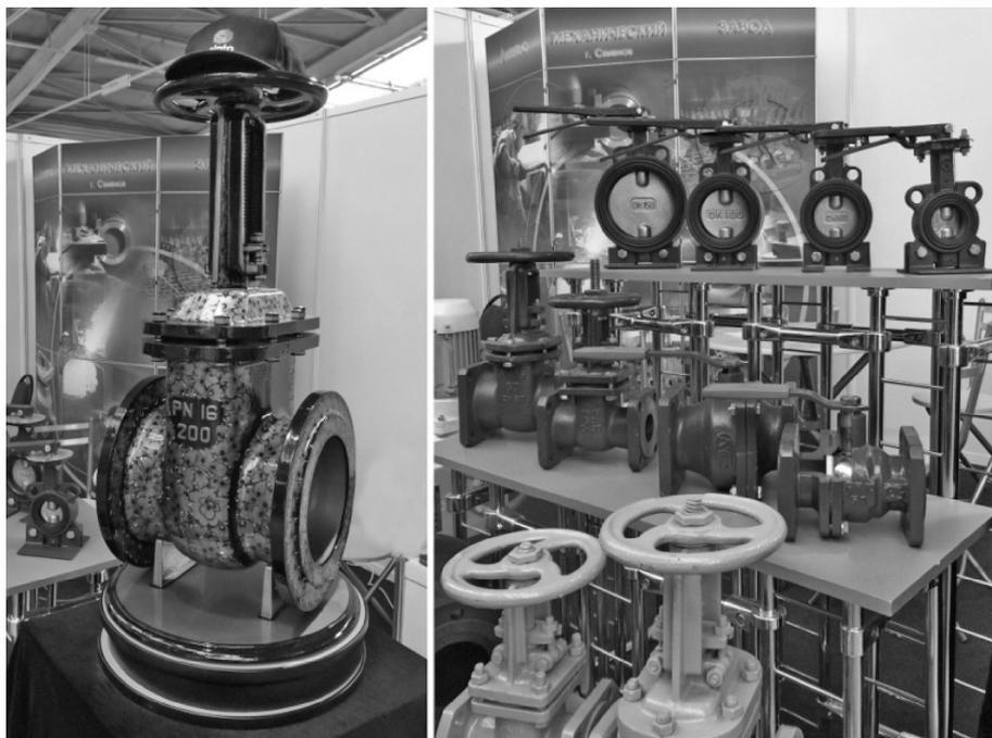
Рис. 3. Отливки с безоपной формовочной линии FBO-III Семеновского литейно-механического завода. Съезд Литейщиков России 2015, г. Нижний Новгород
