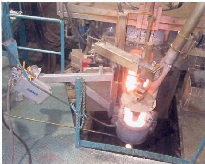
Одновременная дозаливка и разливка, проходящие при использовании лазера OTTO JUNKER, не сказываются на точности дозировки.
