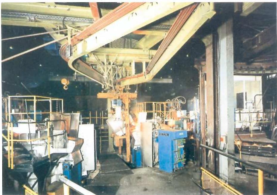
Подача жидкого металла при помощи полностью автоматической ковшовой системы транспортировки и загрузки
