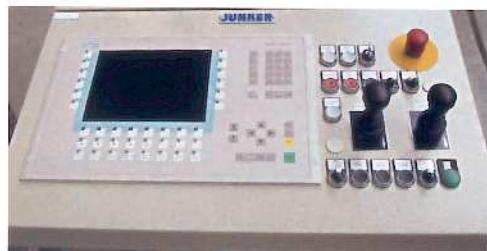
Пульт управления оператора разливочной печи
