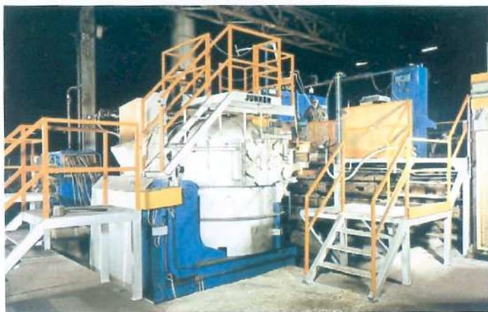
8-тонная разливочная установка для шаровидного серого чугуна
