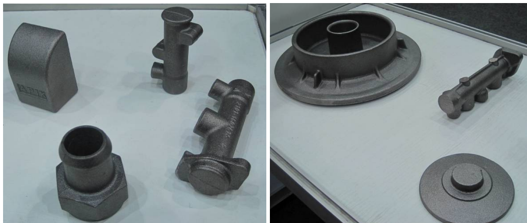
Рис.2. Первые типовые отливки завода Днепропромлит от машины безопочной горизонтальной формовки FBO-II. Выставка ЛитЭкс-09, Днепропетровск, 2009 год.
