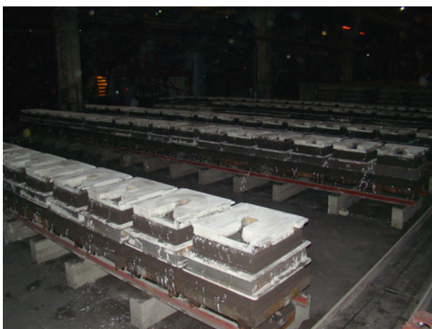
Рис.12. Линия горизонтальной безопочной формовки FBO-IV фирмы HWS-Sinto, Германия на Запорожском сталелитейном заводе
