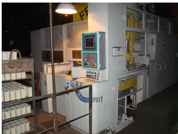
Рис.12. Линия горизонтальной безопочной формовки FBO-IV фирмы HWS-Sinto, Германия на Запорожском сталелитейном заводе
