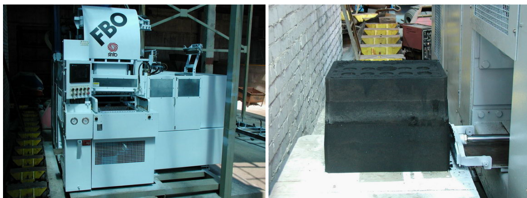
Рис.1. Машина горизонтальной безопочной формовки FBO-II на заводе Днепропромлит в работе
