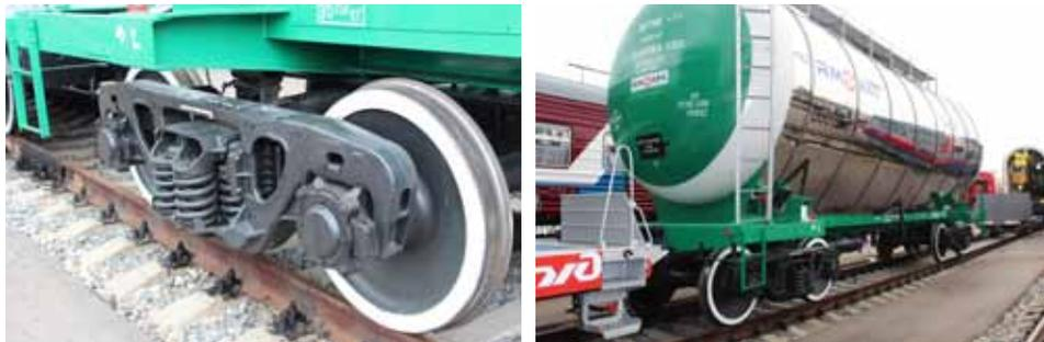
Рис.2. Вагон-цистерна компании РМ Рейл с тележкой новой конструкции на базе отливок производства ВКМ-Сталь.
