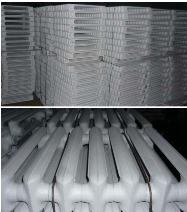
Рис. 9. Новые готовые отливки тонкостенных чугунных радиаторов ЛЛМЗ, г. Луганск, изготовленные по Сейатцу-процессу на наиболее современной и технической совершенной сверхпроизводительной линии немецкой фирмы HWS-Sinto.
