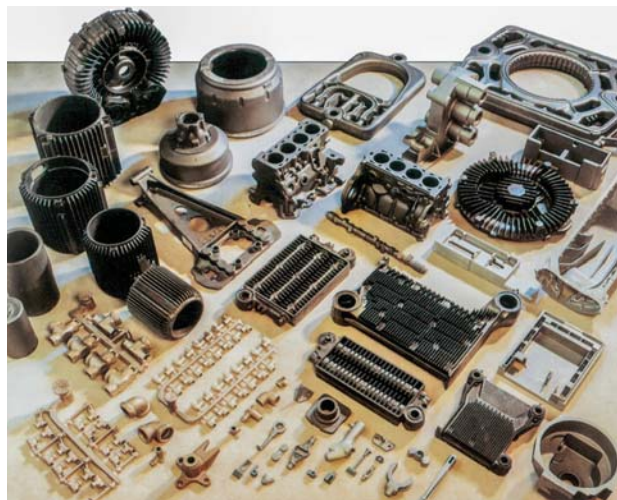
Рис. 11. Сейатцу-процесс позволяет производить самый широкий ассортимент отливок.
