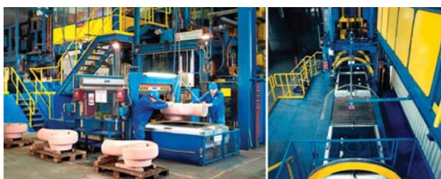
Рис. 7. Современный литейный цех Olsberger Hütte: АФЛ по Сейатцу-процессу (опока 1500x1100x500/500 мм, 35 ф/ч) для чугуновых отливок до 500 кг. Девять ветвей многоэтажного охладителя литейных форм.
