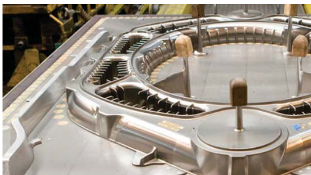
Рис. 2. Завод Buderus. Типовая модельная плита с вентилями для отливки крупной секции котла на АФЛ с технологией уплотнения форм по Сейатцу-процессу.
