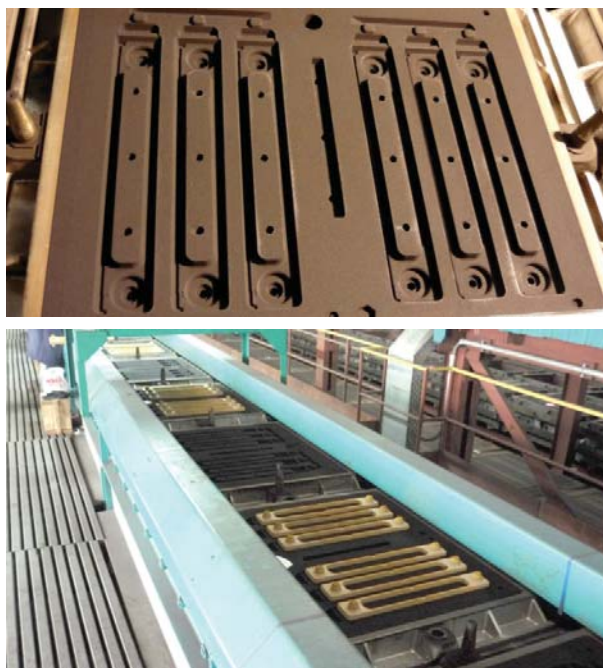
Рис. 10. ЛЛМЗ, г. Луганск, Украина. Участок протановки стержней на АФЛ по Сейатцу-процессу производительностью 240 ф/ч на базе одного формовочного автомата, опока 1020x850x200/200 и 350/200 мм.
