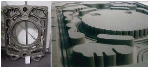
Рис. 1. Отливка (GIFA 2007) и соответствующая полуформа секции крупного котла завода Buderus, Германия, полученная по технологии Сейатцу-процесс на АФЛ фирмы HWS-Sinto, Германия.
