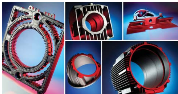
Рис. 6. Секция крупного котла и другие отливки завода Olsberg, Германия, полученные на АФЛ фирмы HWS-Sinto по Сейтцу-процессу.
