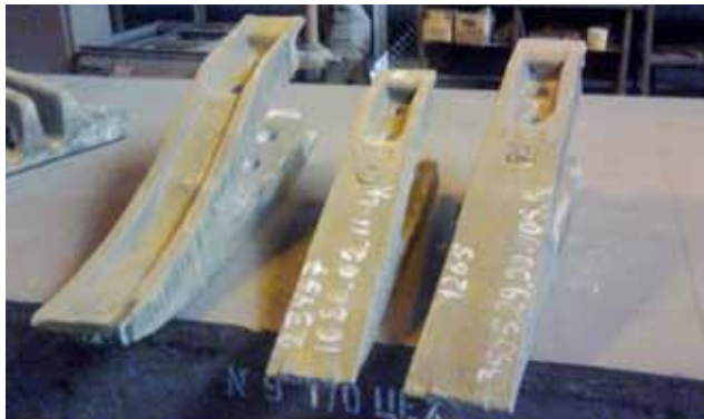
Рис. 4. Пример отливок по ВПФ на заводе КЗГО - стальные отливки зубьев экскаваторов.
