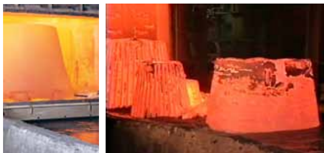
Рис. 9. Опыт завода Frog Switch. Термообработку марганцовистых отливок крайне важно выполнить в кратчайшие сроки после заливки, что обеспечивается ВПФ благодаря простому осыпанию сухого формовочного песка с отливки после отключения вакуума.
