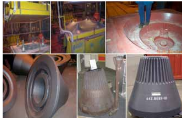
Рис. 7. Подвод, нагрев и наложение пленки на модель, готовые отливки с минимальной обработкой. На заводе Sandvik прочность «вакуумной» формы позволяет ходить по ней для простановки стержней, съема отъемных частей или других технологических операций.
