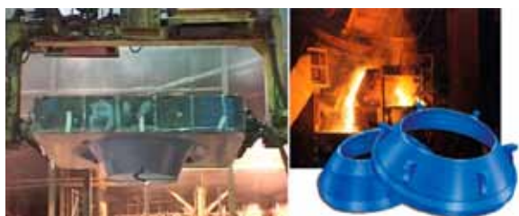
Рис. 8. Завод Frog Switch, США. Технологические операции получения готовой полуформы для отливки конуса дробилки на линии ВПФ. Модель с съемными элементами, которые затем вынимают из готовой полуформы (отливка без стержней).
