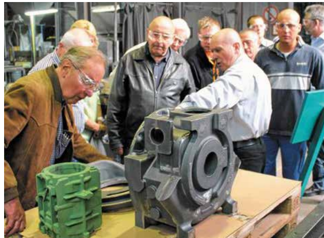
Рис. 1. Отливка корпуса насоса по Сейатцу-процессу завода EMG Casting.
