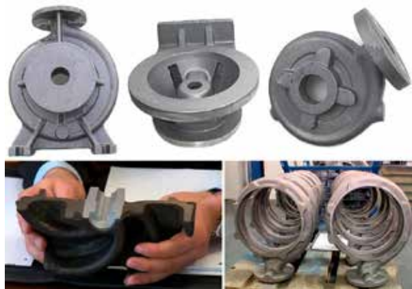
Рис. 5. Примеры производственной программы и демонстрация качества внутренней структуры отливки рабочего колеса насоса. Отливки корпусов насосов завода Herborner Pumpenfabrik
