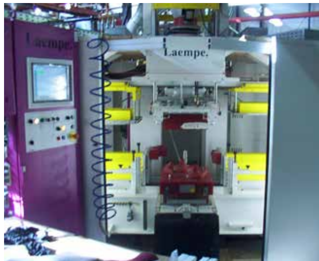
Рис. 3. Общий вид стержневого автомата Laempe тип L20 на литейном заводе Harz Guss Zorge.
