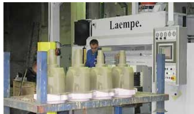
Рис. 10. Производство стержней на стержневом автомате Лаемпе типа LFB80 (80 литров) на заводе Schmiedeberger Gie erei.
