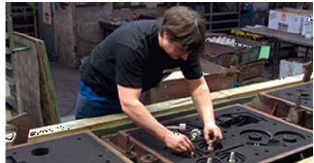
Рис. 9. Операции простановки стержней на АФЛ по Сейатцу-процессу завода Schmiedeberger Gie erei. В одной форме несколько различных типов отливок (по размеру и конфигурации).
