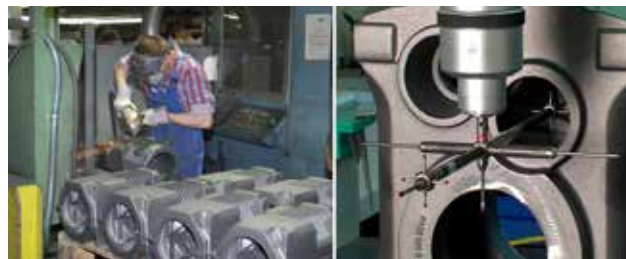
Рис. 2. Контроль и обработка готовых чугунных отливок изготовленных на АФЛ по Сейатцу-процессу. Завод Harz Guss Zorge
