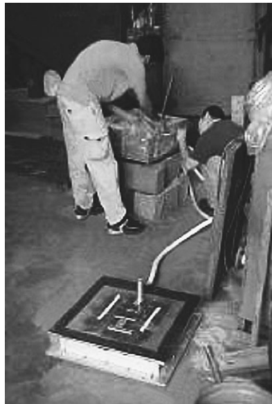
▲ Рис. 5. Подготовка к первому производству Mg-отливки по V-процессу, Jones Engineering, Co
