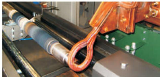
Индукторы и технологическая оснастка для крепления нагреваемых деталей могут быть изготовлены заказчиком, либо быть приспособлены из числа использовавшихся ранее.
