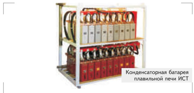
Конденсаторная батарея плавильной печи ИСТ
