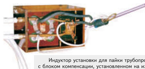
Индуктор установки для пайки трубопроводов с блоком компенсации, установленном на изделии
