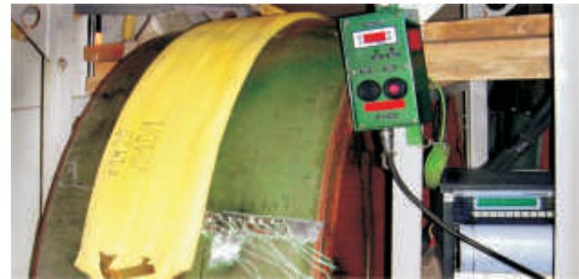
фланцев и др. Возможность приспособливать индуктор в течение процесса нагрева к форме изделия позволяет в реальном времени контролировать нагрев нужной области и так изменять его положение, чтобы получить наилучший результат.
