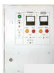
Блок контроля футеровки и изоляции индуктора
