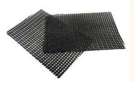
$1650^{\circ}$ С. Основа фильтра представляет собой сетчатую структуру с поверхностной плотностью  $510...550~\text{г/m}^2$  и размерами фильтрующих ячеек: 1,5x1,5мм; 2,0x2,0мм, толщина фильтра – 0,9...1,2 мм. Геометрическая форма – прямоугольник. Размеры фильтра рассчитываются по методикам исходя из конкретных технологических условий производства отливок.
