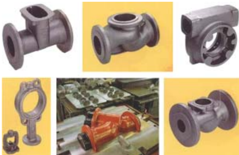
Рис.2. Типовые отливки и модельные плиты фирмы ZETKAMA
