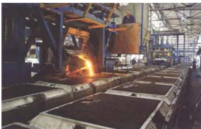
Рис.7. Заливка на автоматической формовочной линии фирмы HWS
