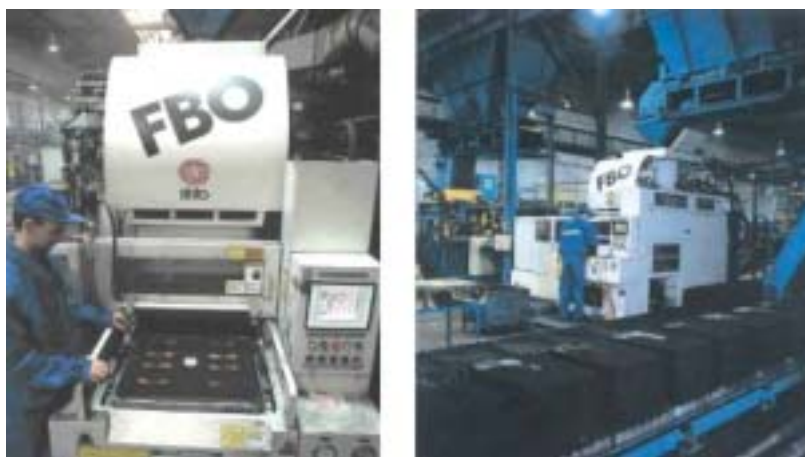
Рис.3, а, б. Простановка стержней на автоматической формовочной линии модели FBO в цехе фирмы ZETKAMA
