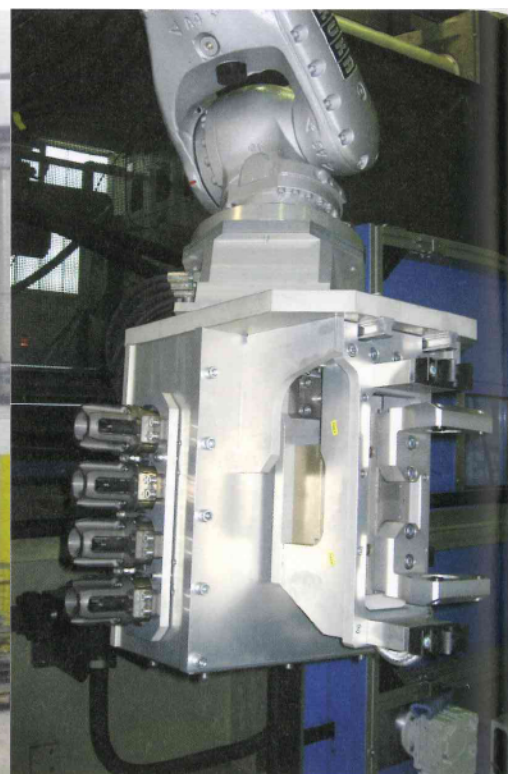
Рис. 6. Комбинированный захват робота для установки гильз цилиндров и извлечения литья.
