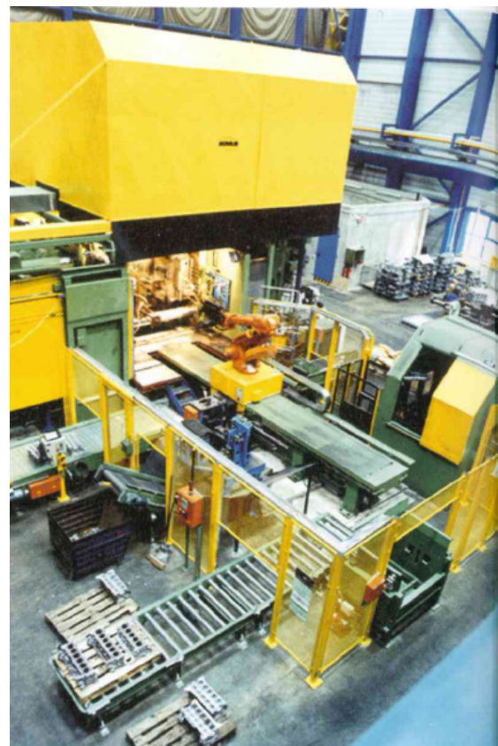
Рис. 2. Полностью автоматический участок литья под давлением на базе МЛД GDK 2500 с оптимизированной конструкцией систем автоматизации.
