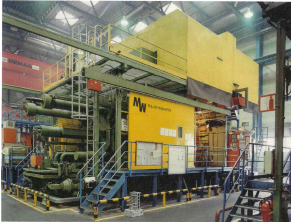
Рис. 1. Первый полностью автоматический участок литья под давлением на базе машины GDK 2800 на предприятии Кольбеншмидт
