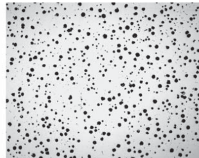
Рис.3. Отливки №3 и №4. Графит шаровидный, типы ОА, ОВ №5, x100
