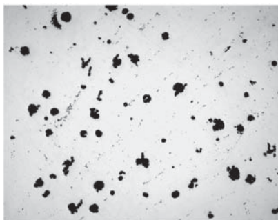
Рис.1. Отливка №1. Графит шаровидный, тип ОВ №5, x100
