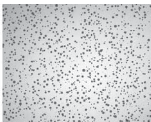
Рис. 3. Отливка №4. Графит шаровидный, ССГ 90% (x100)
