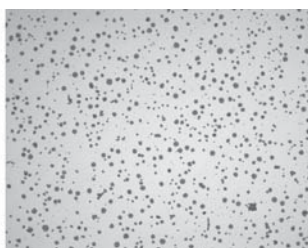
Рис. 2. Отливка №2. Графит шаровидный, ССГ 80% (x100)
