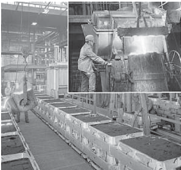
Рис. 2. Заливка на участке формовочной линии HWS
