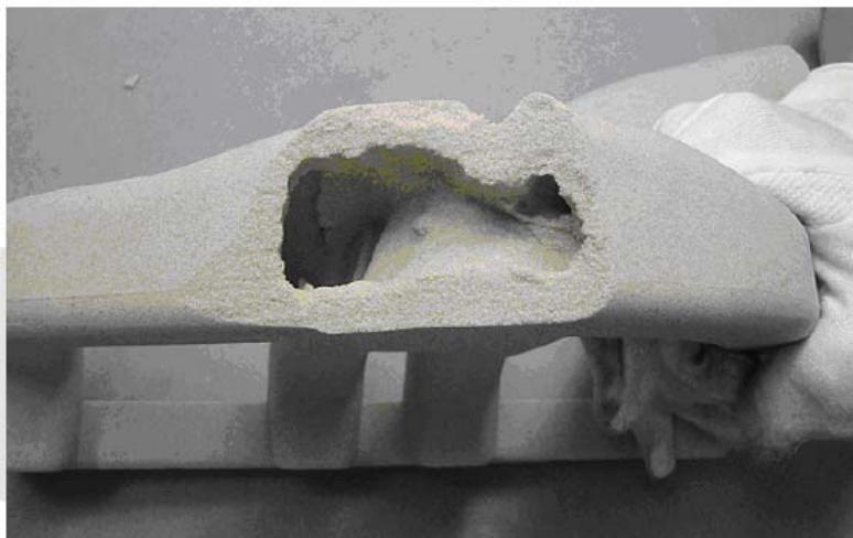
Рис. 2 Стержень на основе связующего CORDIS впускного патрубка, формирование твердой оболочки сразу после извлечения из машины
