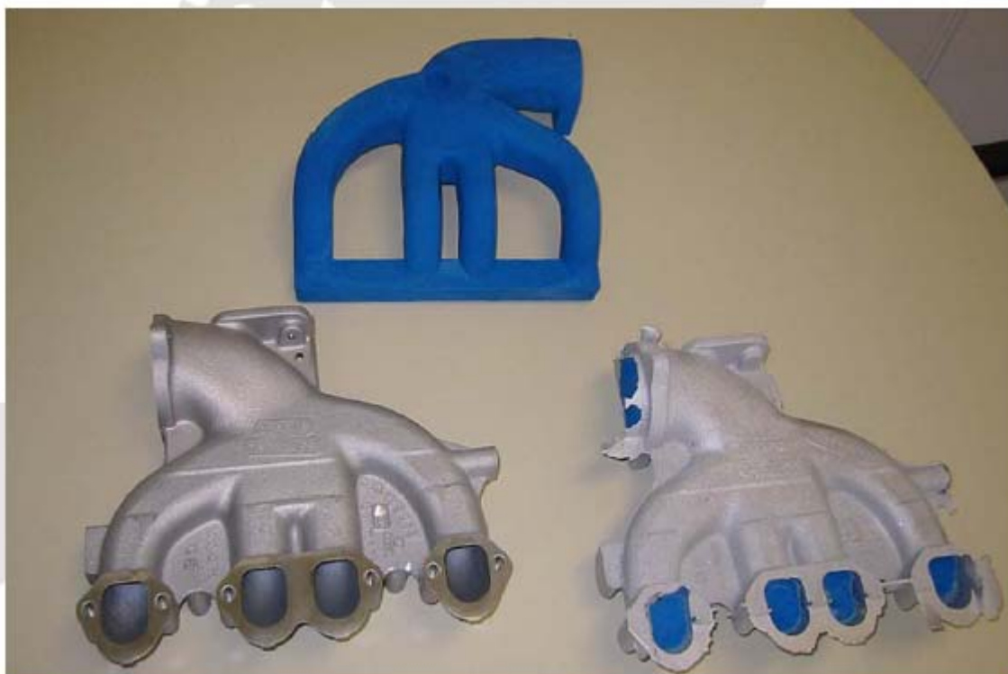
Рис. 3 Выпускной патрубков полученный с использованием связующего CORDIS: а - стержень CORDIS; б – стержень CORDIS после заливки; в – отливка, полученная с использованием стержня CORDIS
