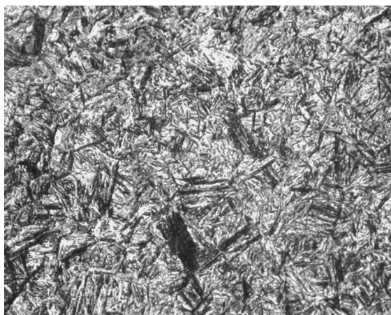
Рис.7. Микроструктура сердцевины образца ст. 40X прошедшего закалку при 250 об/мин. Снято при увеличении 400 крат.
