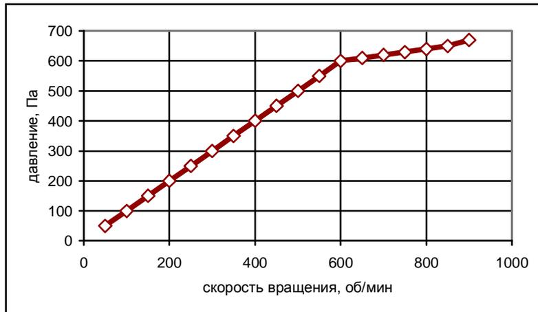
Рис. 2. Изменение скорости потока закалочного масла в зависимости от скорости вращения крыльчатки потокообразователя.
