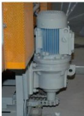
Цепной привод здесь размещаем строго по центру пода, нагрузки на редуктор минимальны, но данная конструкция, конечно, требует использование специальных жаростойких цепей. С 1997 года ЗАО «НПК «Накал» поставило около 3000 печей с
