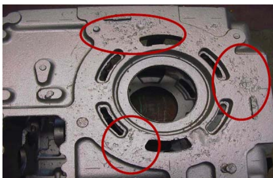
Рис. 5. Отливка из серого чугуна с газовыми дефектами по вине остаточного содержания в смеси растворителей с высокой точкой кипения
