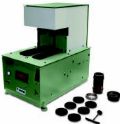
Рис. 4. Прибор GF / Simpson Gerosa для измерения прочности на разрыв в зоне конденсации влаги
