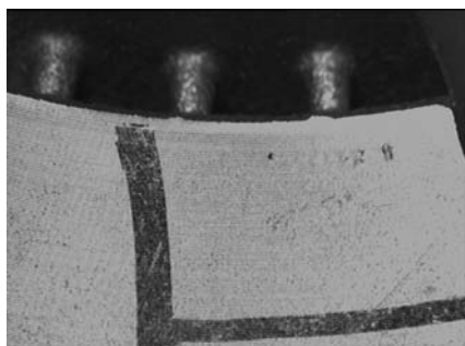
Рис. 3. Отливка из серого чугуна после механической обработки: заметна ситовидная пористость по вине повышенного содержания азота в ОС
