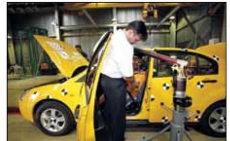
Рис.3. PowerINSPECT и переносной манипулятор «рука» при обработке данных «краш-теста»
