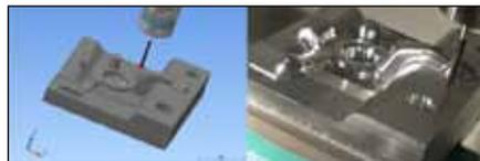
Рис. 5. PowerINSPECT OMV – контроль детали на станке
